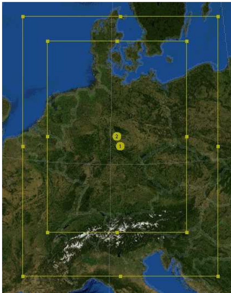
Abb. 2: Multiples Nesting-Verfahren mit zwei Domains des anemos Windatlas Deutschland 3 km. Domain 1 mit 9 \times 9 \text{ km}^2 und Domain 2 (Nest) mit 3 \times 3 \text{ km}^2 .
